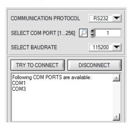
Durch Drücken auf die Lupe in der Registerkarte **CONNECT** werden alle verfügbaren **COM PORTS** aufgelistet.
